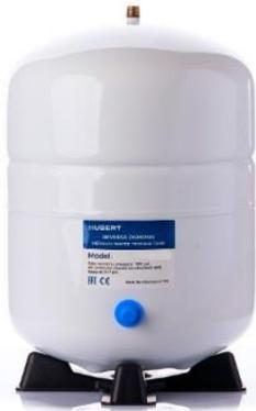
Накопительная емкость HUBERT 2,2G применяется для накопления очищенной воды в системе обратного осмоса, за счет чего происходит компенсация невысокой скорости работы обратноосмотической мембраны. Накопительный бак представляет собой металлический корпус, внутри которого расположена специальная мембрана, при помощи которой внутри корпуса поддерживается постоянное давление для подачи очищенной воды потребителю.
